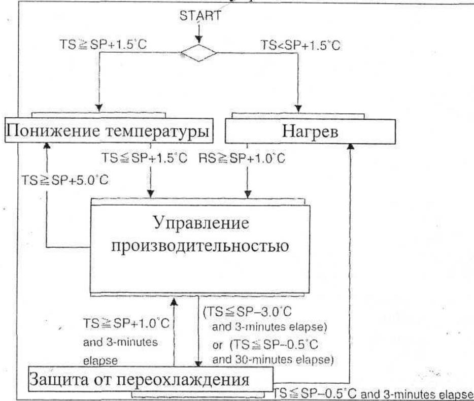
TS : Температурный контроль (датчик поступающего и обратного воздуха)
