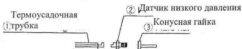
6. Наденьте термоусадочную трубку и зафиксируйте ее с помощью горячего воздуха.
