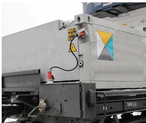
Рисунок 69 – Примеры подключения АДГУ к сети электроснабжения платформы а – подключение АДГУ «Прогрессор-01»; б – подключение АДГУ РКВ-15
